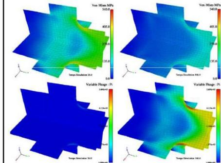
Figure 15 : Carte d'évolution de la contrainte et du fluage d'irradiation dans la vis.
